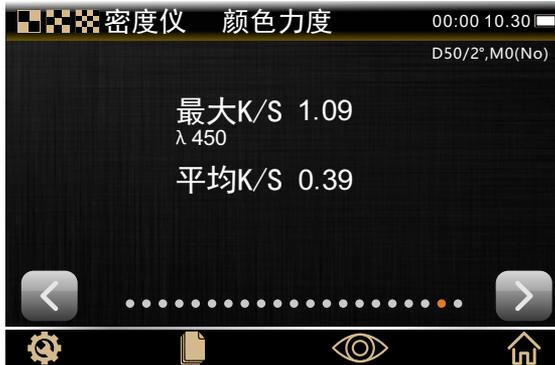
图41 颜色力度测量界面
