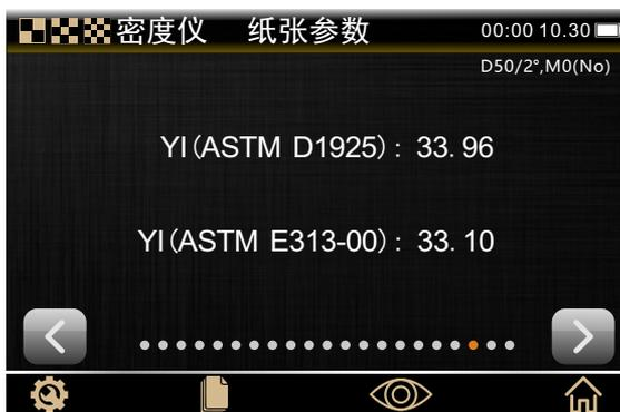
图40 纸张参数测量界面
