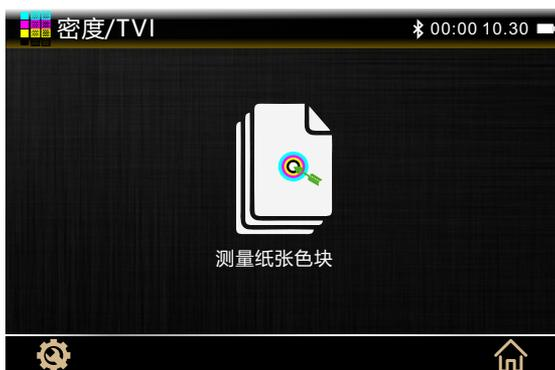
图19 密度/TVI界面提示测量纸张色块
